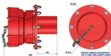
Enchufe hembra empotrable RT 4.2 / con cuerpo separador + flange para SKID + tapa hembra aislada RT.
